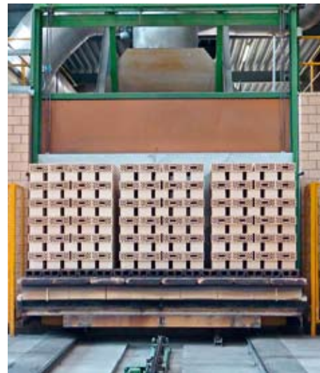
»10 A load of fired products leaving the 100 m-long tunnel kiln »10 Die fertig gebrannten Ziegel verlassen den 100 m langen Tunnelofen
