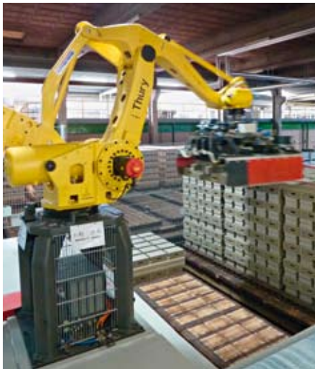
»9 A setting robot nicknamed "Thury" deposits the shaped products on the kiln cars »9 Der Setzroboter „Thury“ platziert die Rohlinge auf die Ofenwagen
